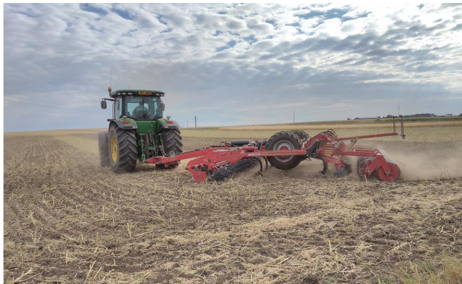
Obr. 17: Mechanicky jsme schopni ovlivňovat pouze vrchní vrstvy půdy do 30 cm. S těžkou technikou však nelze kalkulovat se zlepšením půdních vlastností do větší hloubky.
